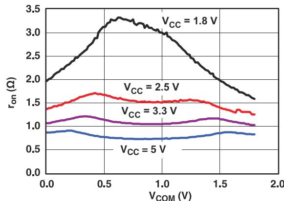
图 9-2. R<sub>on</sub> vs V<sub>COM</sub>
