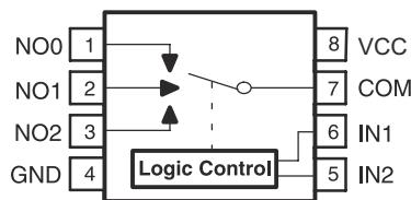
图 5-2. DCU Package 8-Pin US8 Top View
