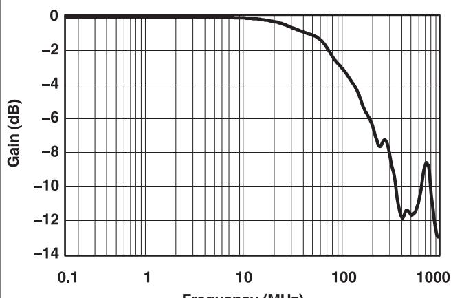
图 6-12. Bandwidth (V<sub>CC</sub> = 5 V)
