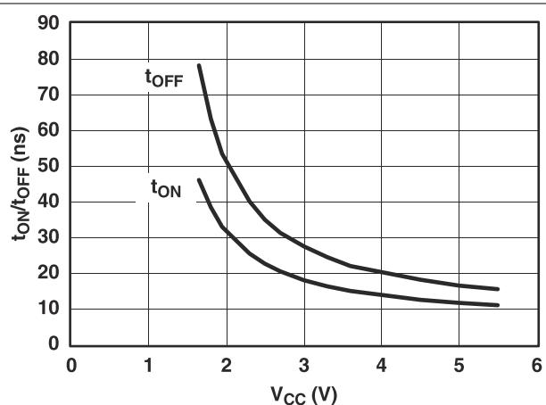
图 6-9. t<sub>ON</sub> and t<sub>OFF</sub> vs Supply Voltage
