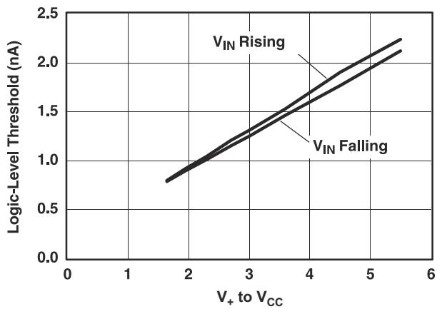
图 6-11. Logic-Level Threshold vs V<sub>CC</sub>
