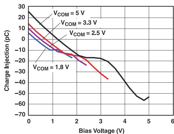
图 6-8. Charge Injection (Q<sub>C</sub>) vs V<sub>COM</sub>
