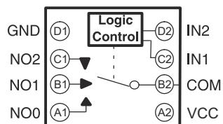
图 5-1. YZP Package 8-Pin DSBGA Bottom View
