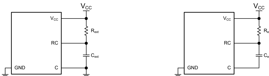
图 7-1. 时序元件连接（带和不带外部接地）
