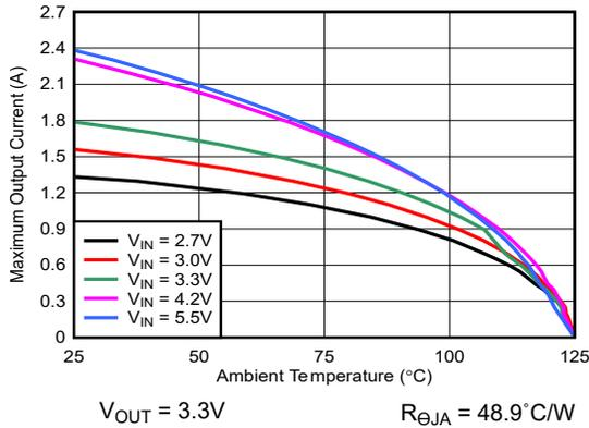
图 8-2. 基于热限制的安全工作区
