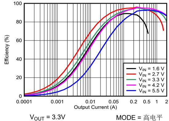
图 8-3. 效率与输出电流间的关系 (FPWM)
