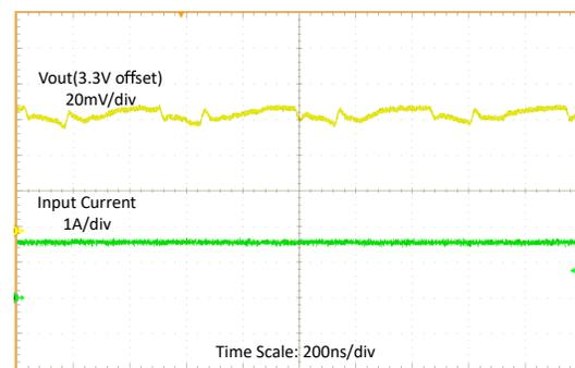
图 8-7. 负载为 1A 并采用升压运行模式时的稳定状态波形
