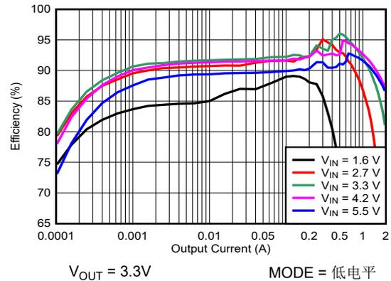
图 8-5. 效率与输入电压间的关系 (PFM)
