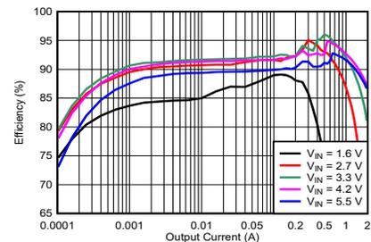
效率与输出电流间的关系 ( $V_{OUT} = 3.3V$ )
