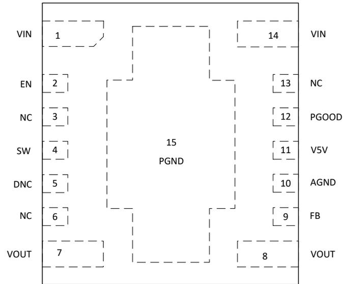
图 5-1. 15-Pin QFN RDA Package (Top View)
