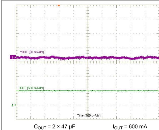
图 8-4. Output Ripple Waveform
