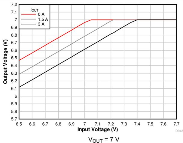
图 7-11. Voltage Dropout
