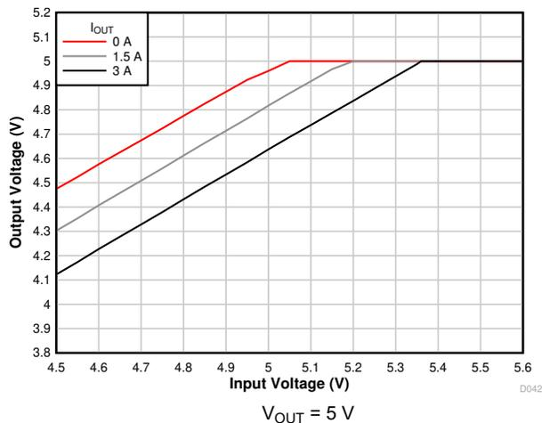
图 7-9. Voltage Dropout
