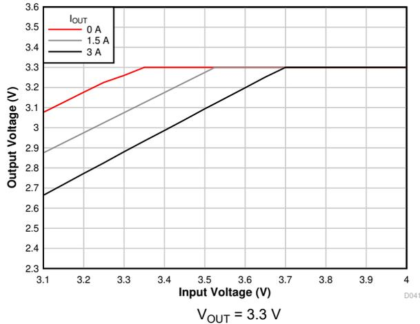
图 7-7. Voltage Dropout
