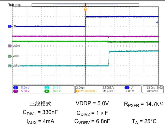
图 8-9.  $t_{LH\_VDRV}$ , 三线模式, TPSI3052-Q1
