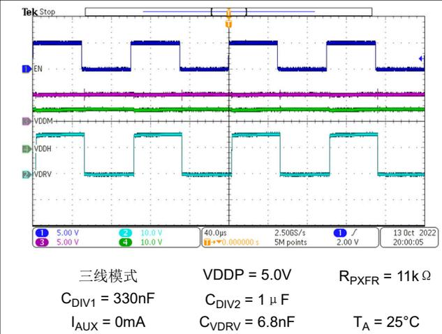
图 8-7. 三线模式,  $f_{EN} = 10\text{kHz}$ , TPSI3052-Q1
