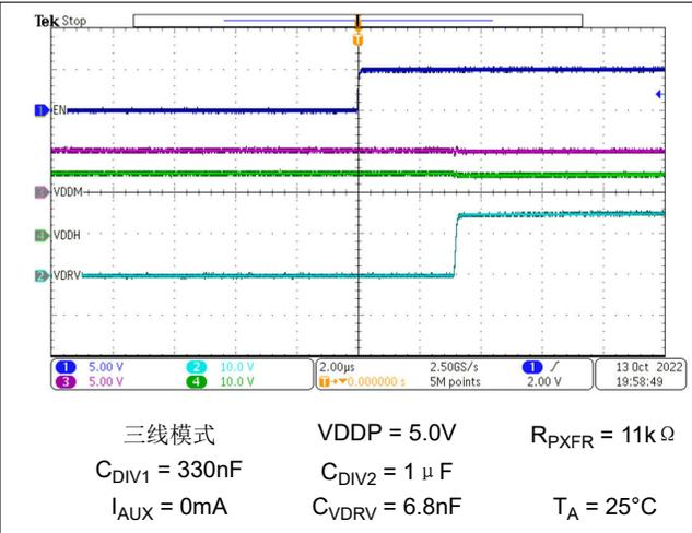
图 8-5.  $t_{LH\_VDRV}$ , 三线模式, TPSI3052-Q1
