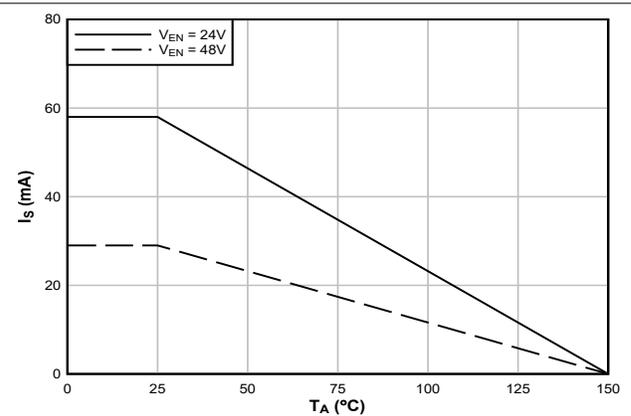
图 5-2. 根据 VDE 和 IEC 标准限制电流的热降额曲线，
