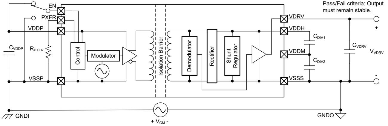
图 6-4. 共模瞬态抗扰度测试电路
