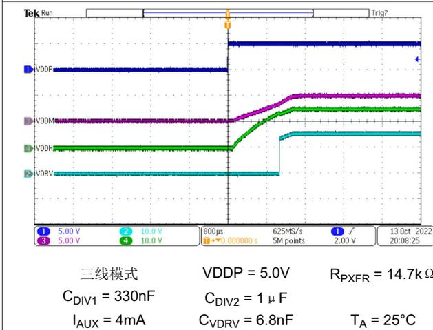
图 8-8. 上电,  $V_{EN} = V_{VDDP}$ , 三线模式, TPSI3052-Q1
