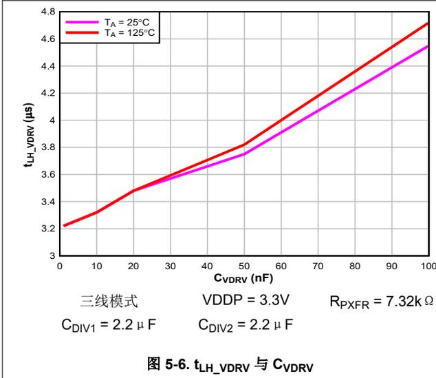
图 5-6. t<sub>LH\_VDRV</sub> 与 C<sub>VDRV</sub>
