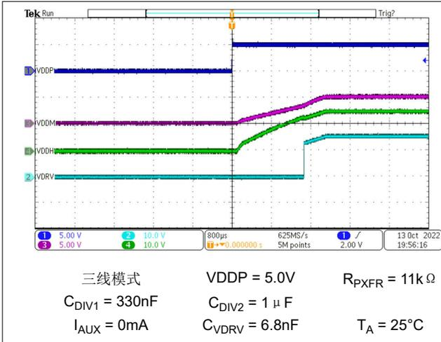
图 8-4. 上电,  $V_{EN} = V_{VDDP}$ , 三线模式, TPSI3052-Q1
