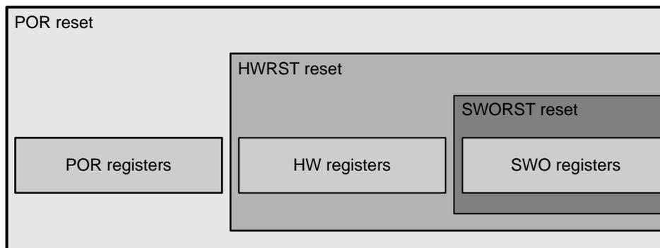
图 5-9. Reset Levels versus Registers
