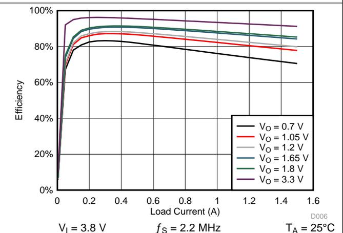
图 4-9. SMPS Efficiency for SMPS4 in PWM Mode
