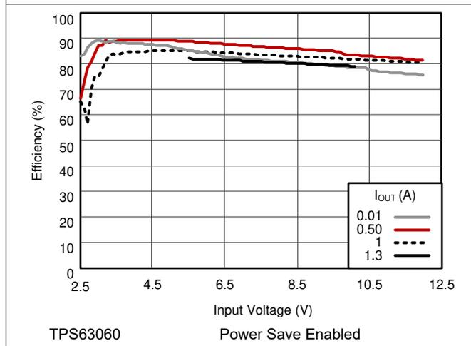
图 9-6. Efficiency vs. Input Voltage
