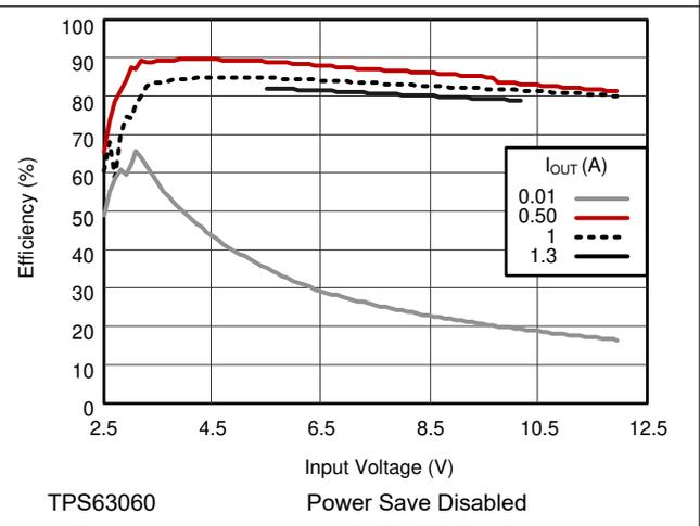
图 9-7. Efficiency vs. Input Voltage
