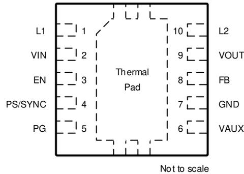
图 6-1. DSC Package 10 Pins (Top View)
