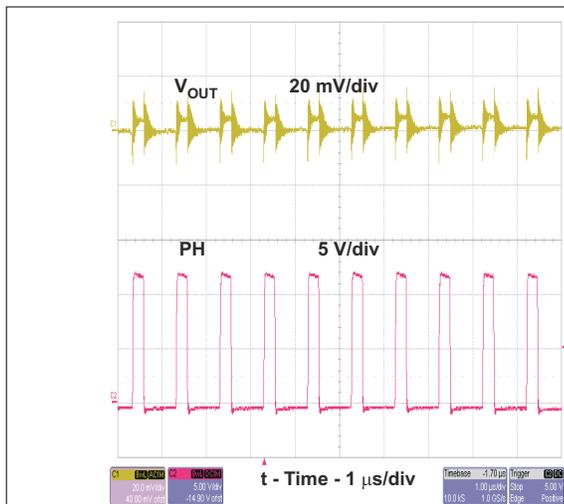
**图 8-8. TPS54332 Output Ripple**
