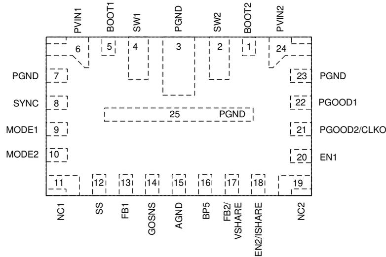
图 5-1. 25-Pin VQFN-HR RPB Package (Top View)
