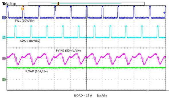
图 8-48. Input Ripple PVIN2 - 12-A Load
