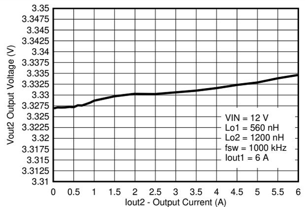
图 8-6.  $V_{OUT2}$  Load Regulation
