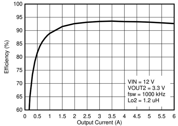
图 8-4.  $V_{OUT2}$  Efficiency
