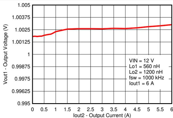
图 8-7.  $V_{OUT1}$  Cross Regulation
