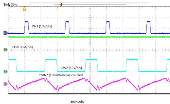
图 8-31. Input Ripple PVIN2 - 6-A Load
