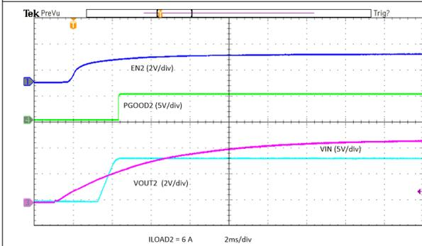
图 8-25. Power Up with  $V_{IN}$   $V_{OUT2}$
