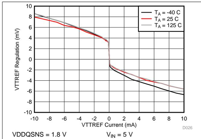
图 25. VTTREF Regulation to VDDQSNS/2 vs I(VTTREF)
