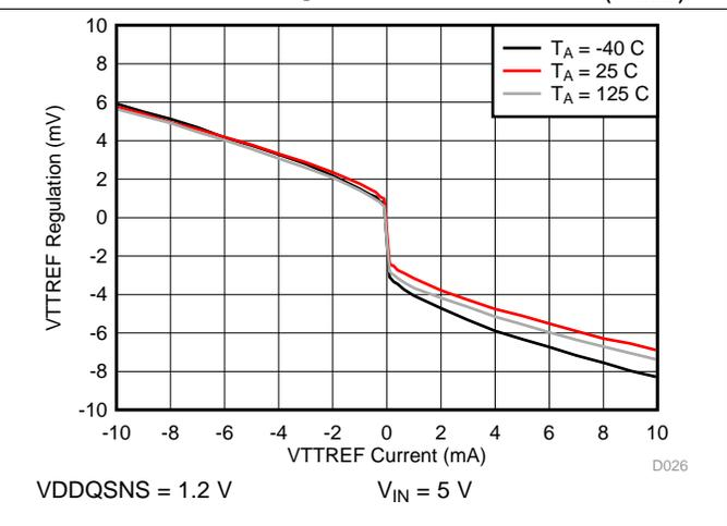
图 28. VTTREF Regulation to VDDQSNS/2 vs I(VTTREF)
