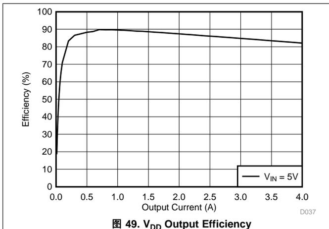
图 49.  $V_{DD}$  Output Efficiency
