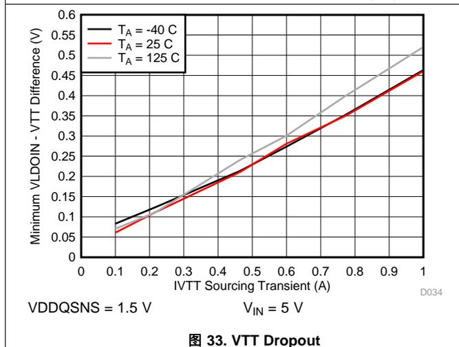
图 33. VTT Dropout
