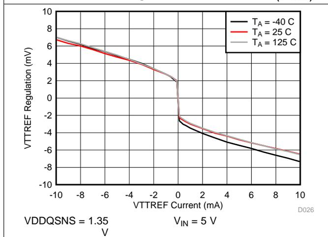
图 27. VTTREF Regulation to VDDQSNS/2 vs I(VTTREF)
