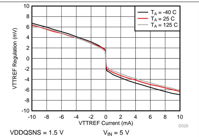
图 26. VTTREF Regulation to VDDQSNS/2 vs I(VTTREF)
