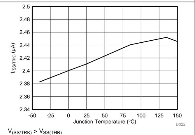
图 22.  $I_{(SS/TRK)}$  vs Temperature
