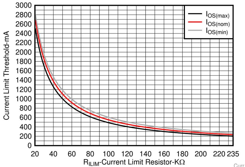
图 24. Current-Limit Threshold vs Current-Limit Resistor (R<sub>ILIM</sub>)
