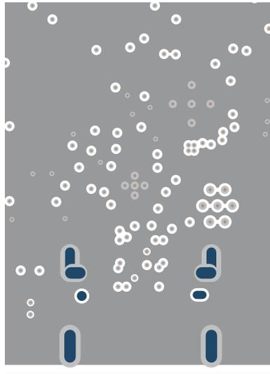
图 7-6. TPS26750 PCB 布局 - GND 层 2
