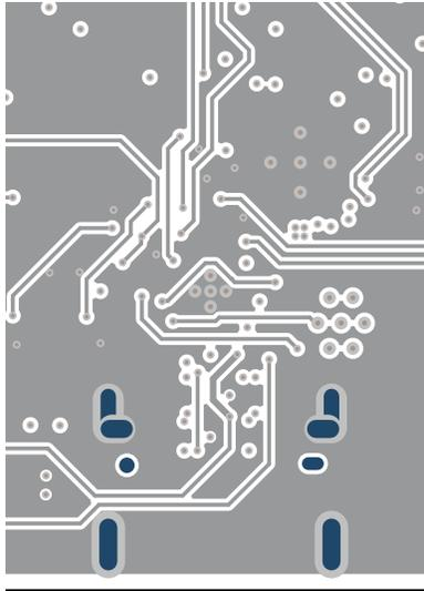
图 7-7. TPS26750 PCB 布局 - 信号层 3
