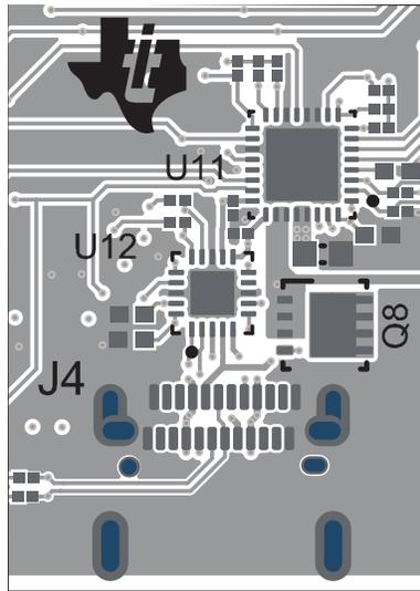
图 7-3. TPS26750 PCB 布局 - 顶部复合图
