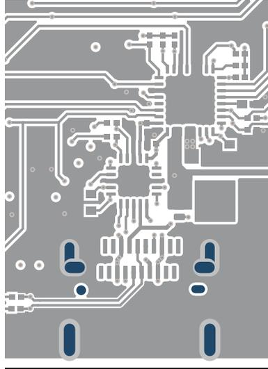
图 7-5. TPS26750 PCB 布局 - 顶层 1
