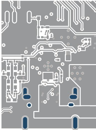
图 7-10. TPS26750 PCB 布局 - 底层 6
