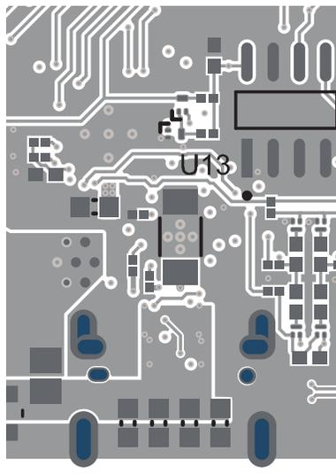
图 7-4. TPS26750 PCB 布局 - 底部复合图
