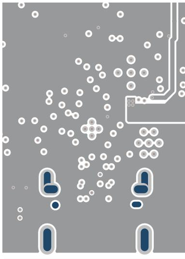
图 7-8. TPS26750 PCB 布局 - 信号层 4
