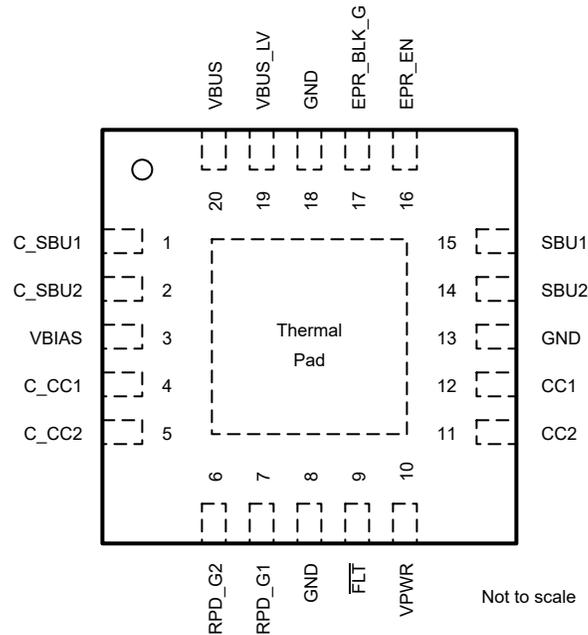
图 4-1. RUK 封装 20 引脚 QFN
