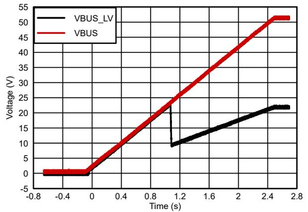
图 5-8. EPR\_EN 为低电平时的 VBUS 扫描
