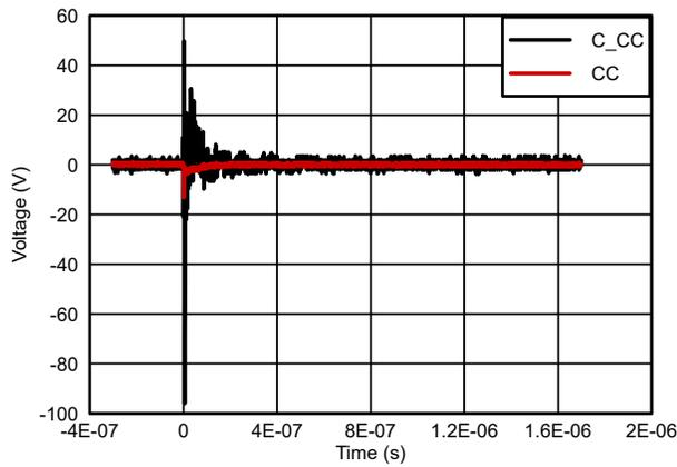
图 5-7. CC IEC 61000-4-2 -8kV 响应波形
