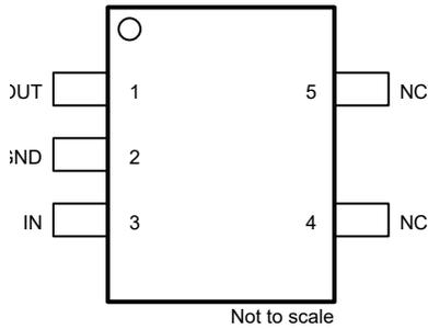
图 5-1. DBV Package, 5-Pin SOT-23 (Top View)
