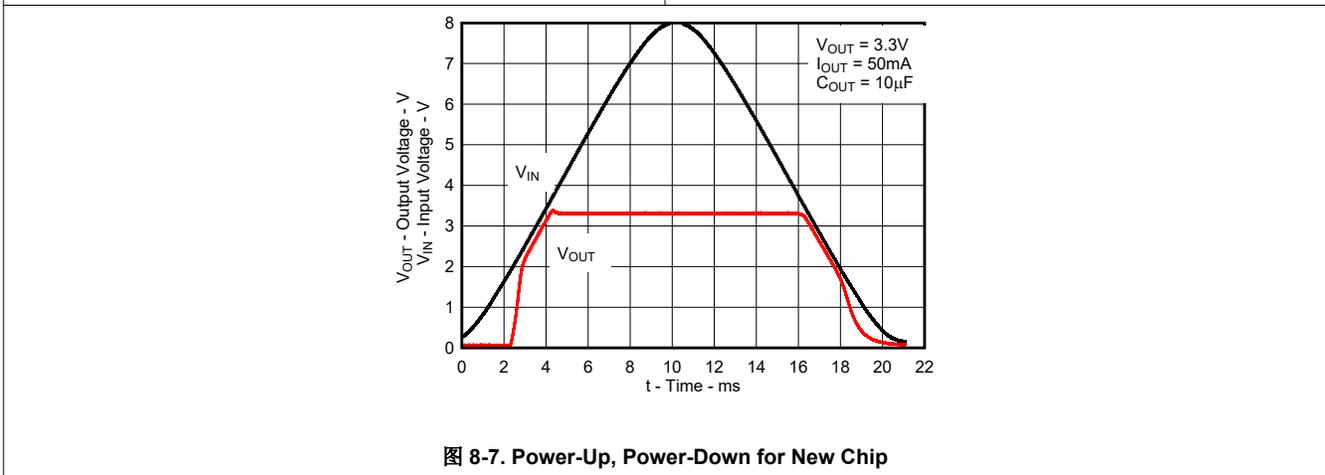
图 8-7. Power-Up, Power-Down for New Chip
