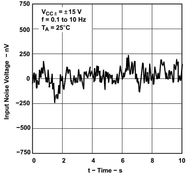
图 5-26. 10 秒周期内的输入噪声电压
