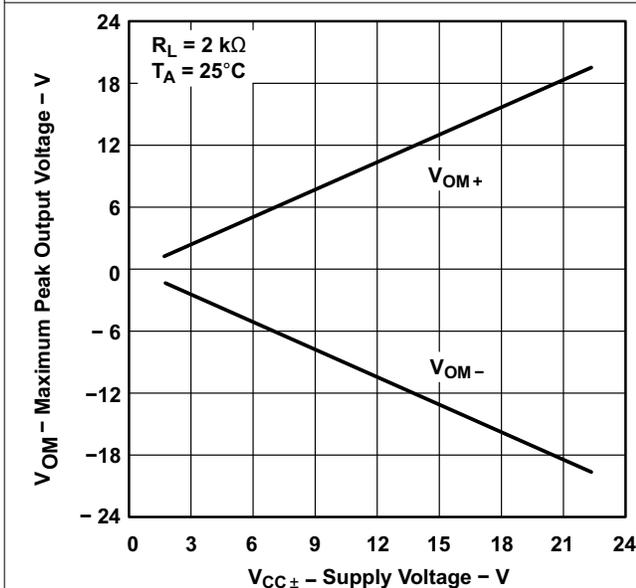
图 5-7. 最大峰值输出电压与电源电压间的关系
