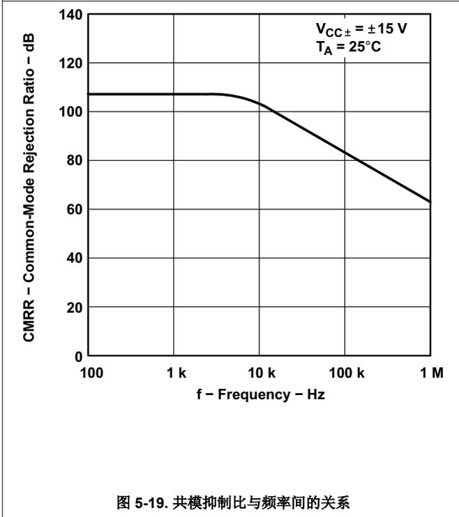
图 5-19. 共模抑制比与频率间的关系
