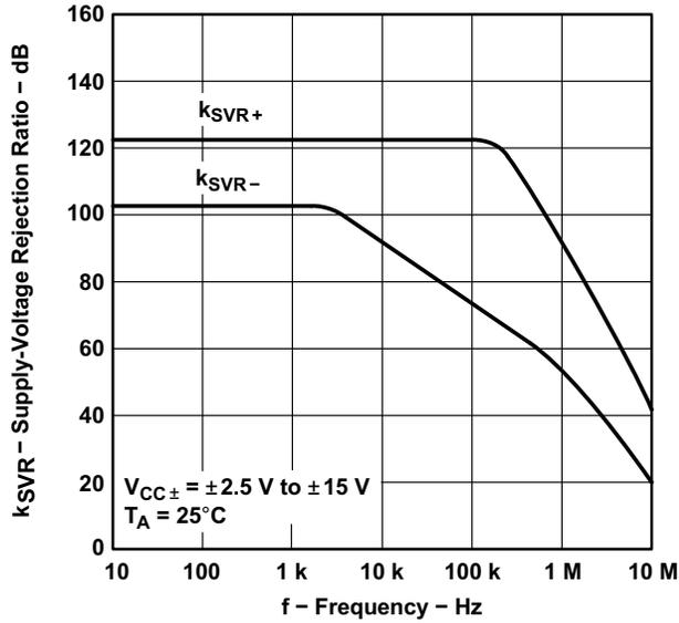
图 5-21. 电源电压抑制比与频率间的关系
