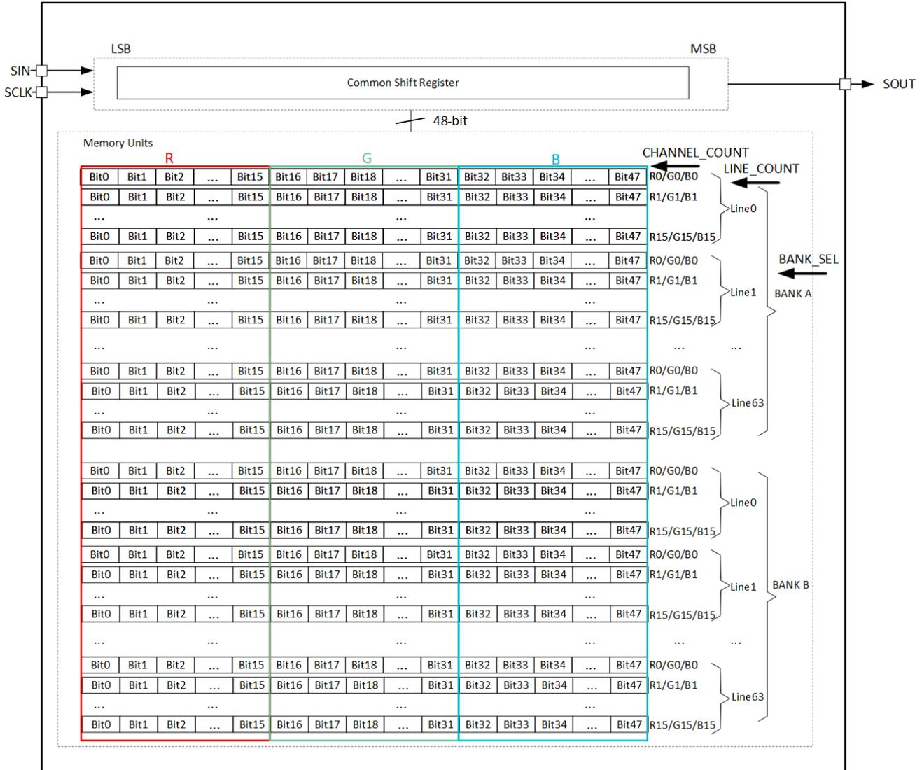
图 8-27. TLC6984 Memory-unit Structure
