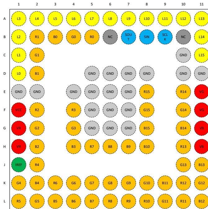
图 6-2. TLC6984 ZXL Package 96-Pin BGA Top View
