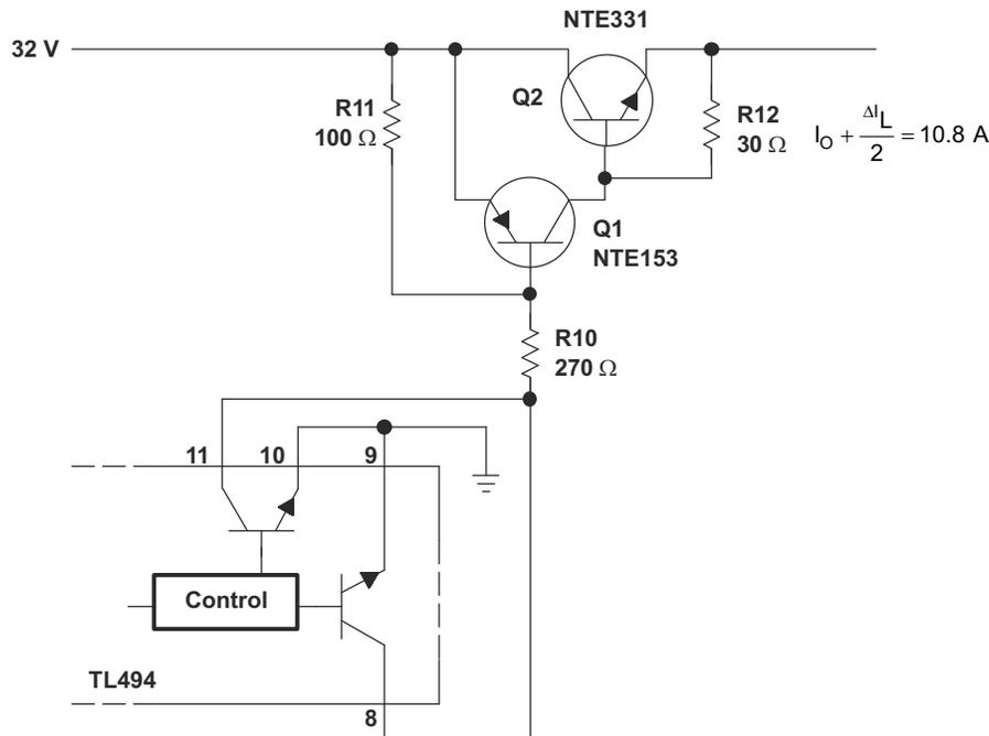
**Figure 10-7. Power-Switch Section**
