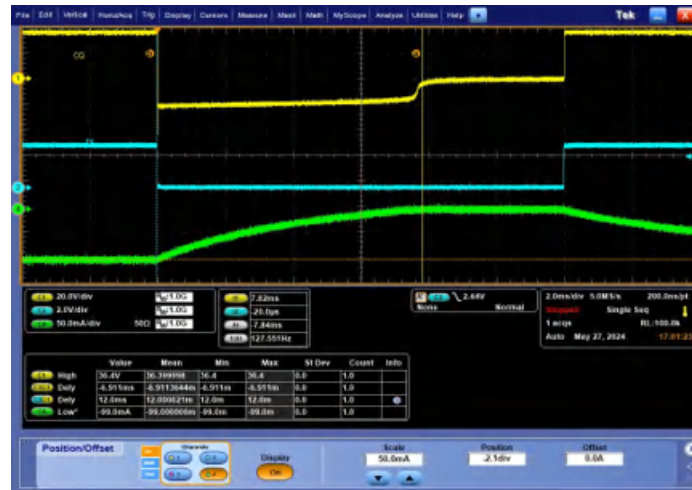
图 9-5. CQ 上电延迟、 t_{(UVLO)} (引脚模式或 SPI 模式下的默认 00b 设置)
