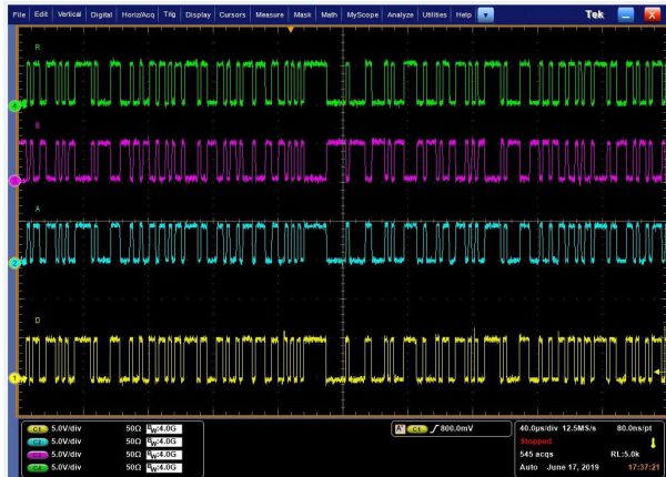
THVD2410 V_{CC} = 5V R_L = 50\Omega 500kbps 速率下的随机 (PRBS7) 数据
