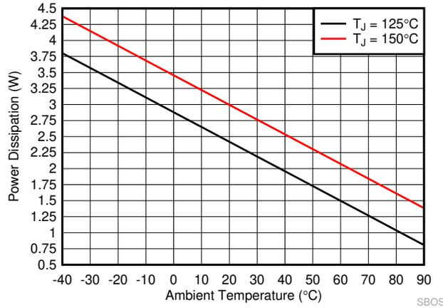
图 6-2. Package Power Dissipation vs Ambient Temperature
