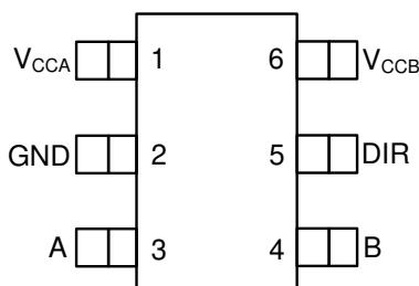
图 5-1. DBV Package 6-Pin SOT-23 Top View
