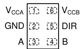
图 5-4. DRY Package 6-Pin SON Transparent Top View
