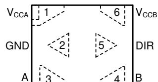
图 5-3. DTQ Package 6-Pin X2SON Transparent Top View
