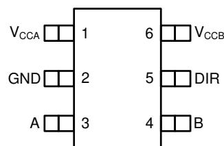
图 5-2. DCK Package 6-Pin SC70 Top View
