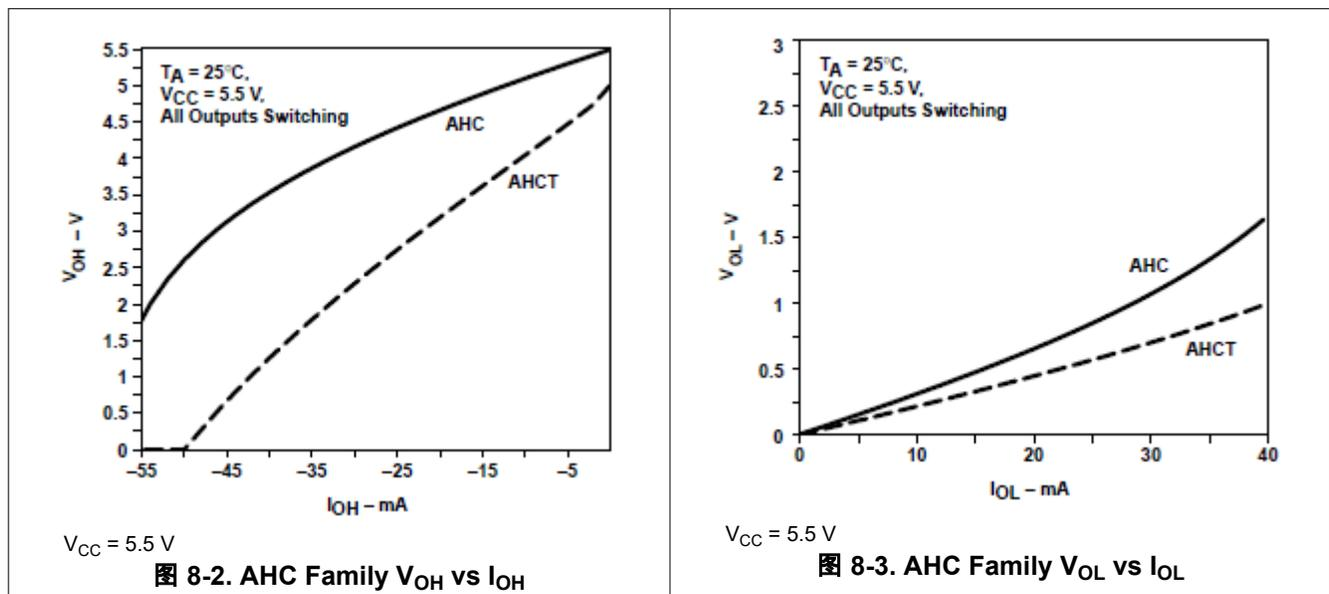
图 8-2. AHC Family  $V_{OH}$  vs  $I_{OH}$
