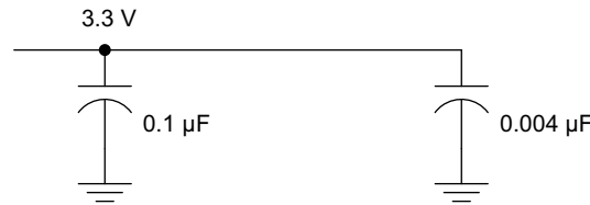
图 9-2. 建议的 M-LVDS 旁路电容器布局
