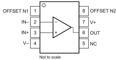
**图 5-1. D Package, 8-Pin SOIC,
