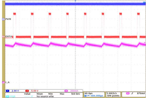
图 9-16. 带电流斩波的驱动器 100% 运行
