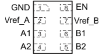
图 4-2. LSF0102 DQE 封装，8 引脚 X2SON（透明顶视图）
