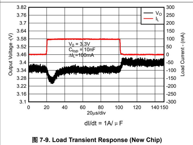
图 7-9. Load Transient Response (New Chip)
