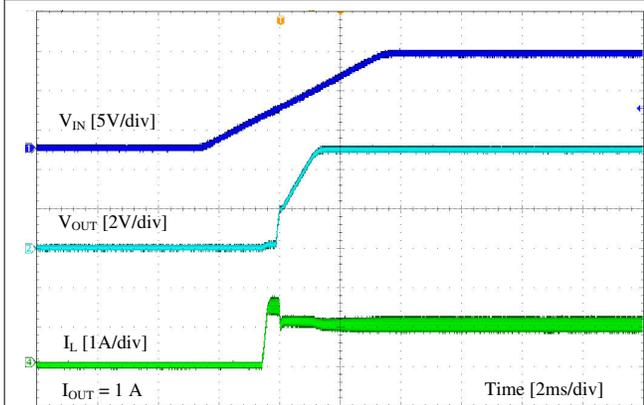
图 8-5. 由  $V_{IN}$  启动
