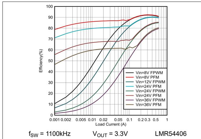
图 6-1. 效率与负载电流间的关系 (3.3V)
