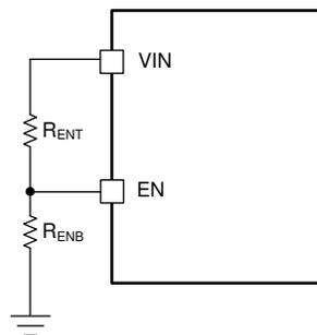
图 7-3. 由使能分压器实施的系统 UVLO
