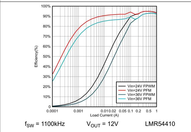
图 6-6. 效率与负载电流间的关系 (12V)
