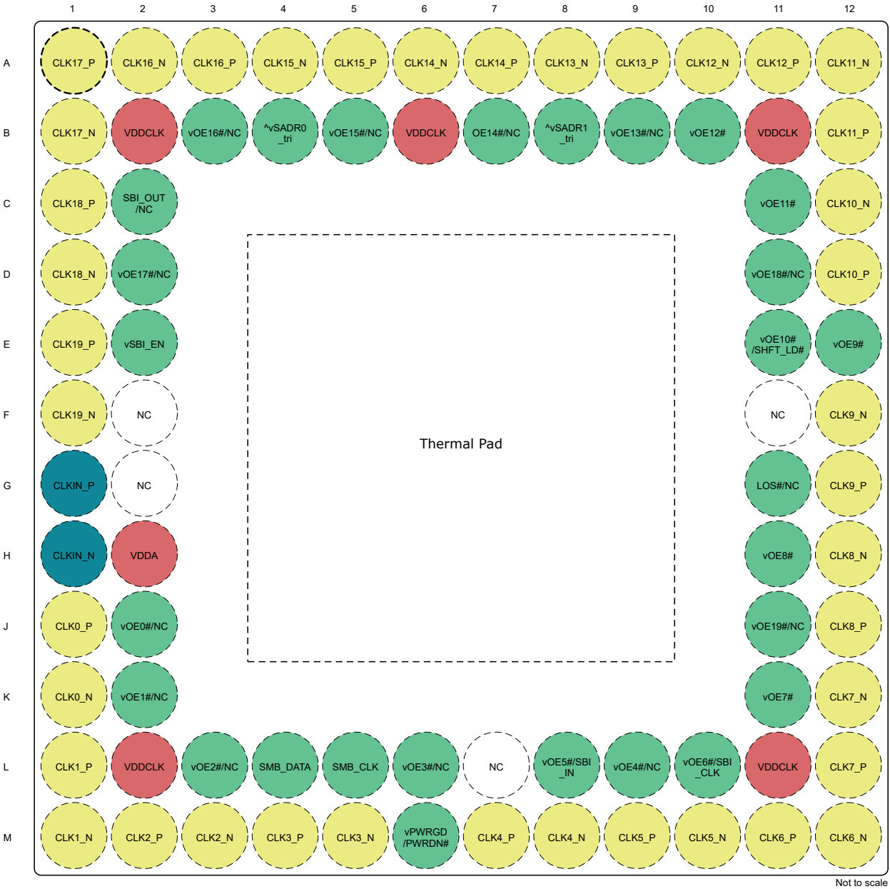
图 5-1. LMKDB1120 和 LMKDB1120FS 6mm x 6mm NPP 封装 80 引脚 TLGA 顶视图
