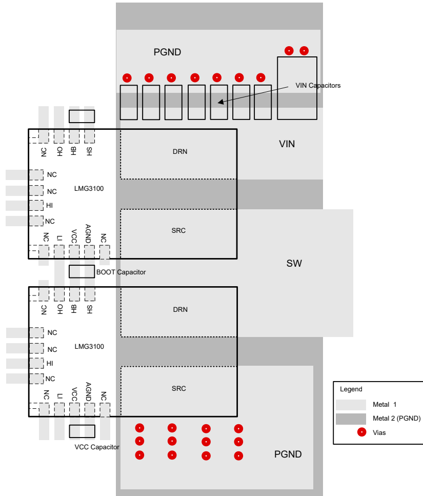
图 8-6. 外部元件放置方式 ( 多层电路板 )
