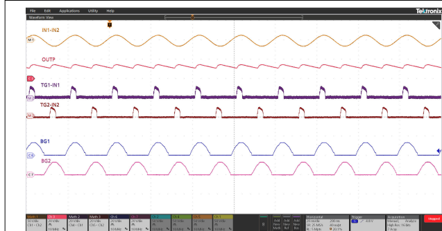
图 8-8. 10V 交流输入、 C_{OUT} = 1\text{mF} 、稳态
