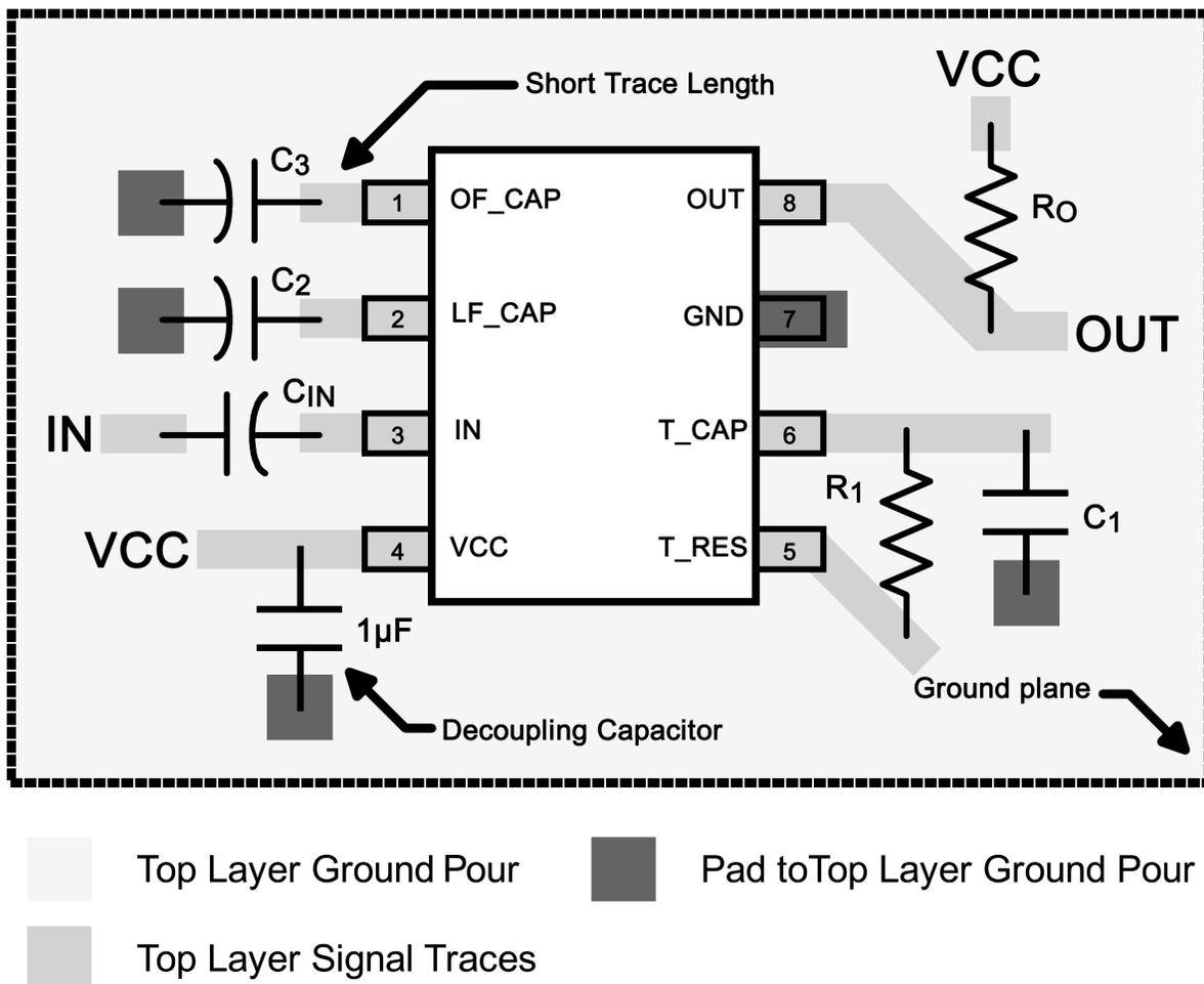
图 12-1. LM567 Layout Example
