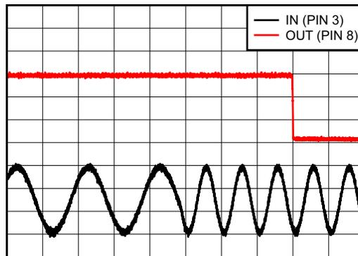
图 10-2. Frequency Detection
