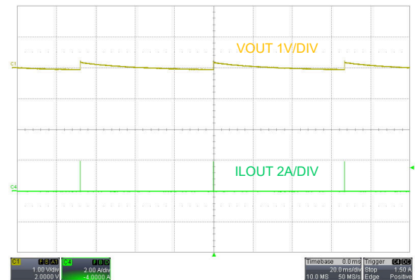
图 7-10. PFM 模式、 V_{SUPPLY} = 48V 、 I_{LOAD} = 0A 条件下的空载运行
