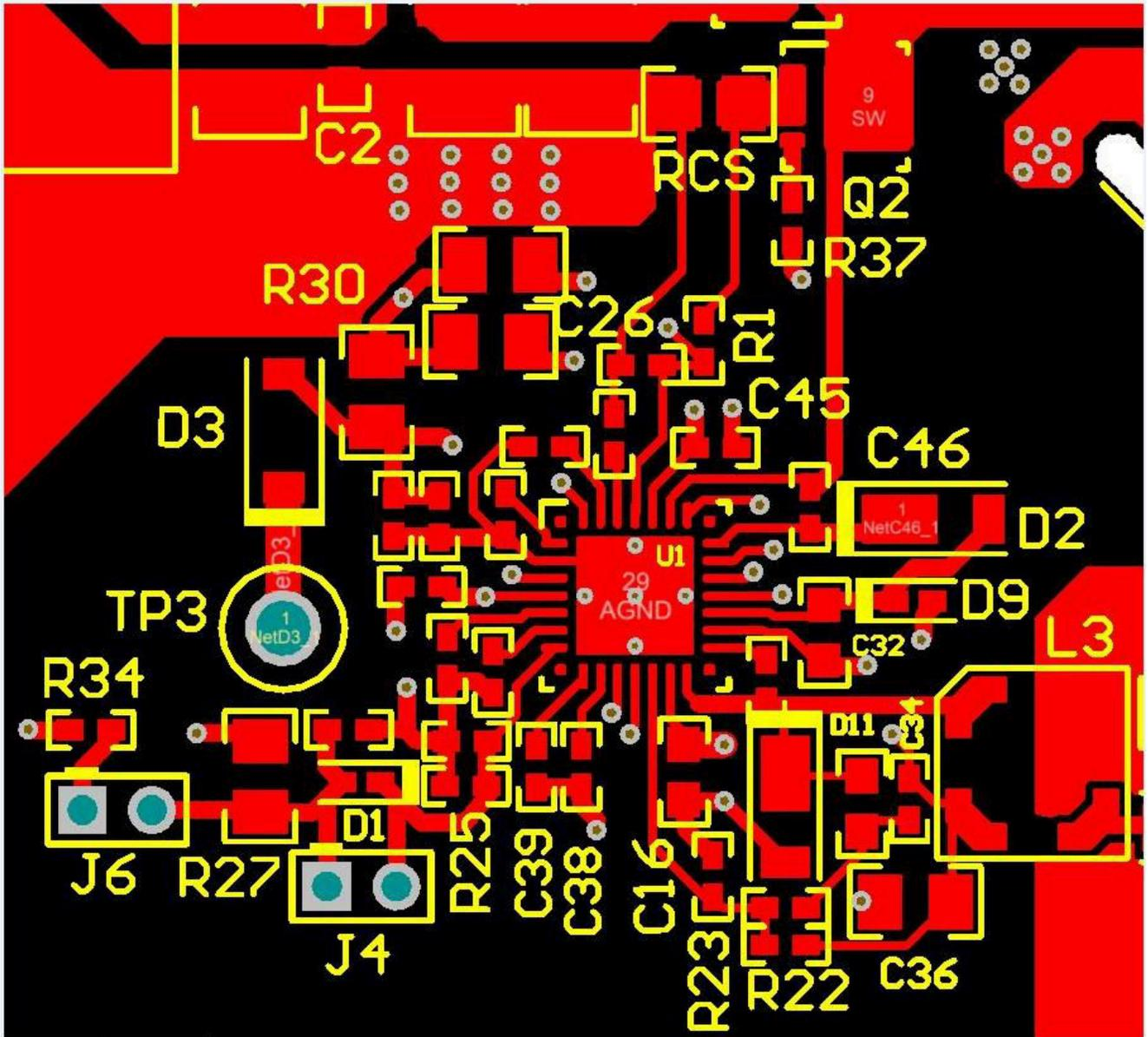
图 10-1. LM5036 PCB Layout Example
