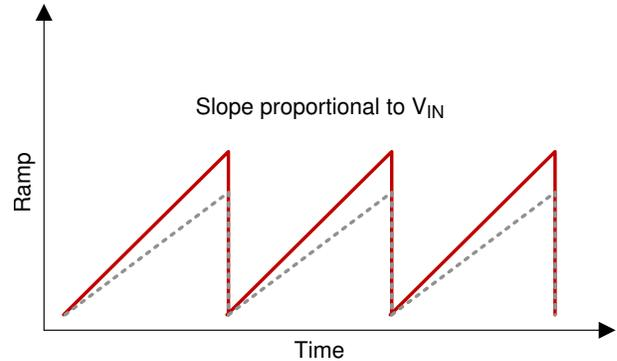
图 7-4. Modulation Ramp Slope
