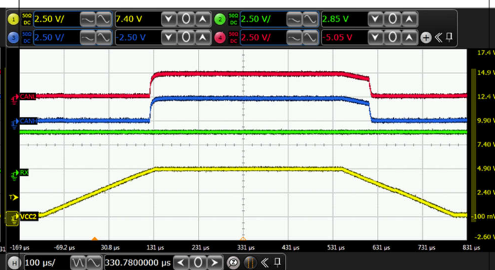
图 5-12. 1Mbps 时的典型 TXD、RXD、CANH 和 CANL 波形
