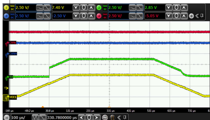
图 5-13. V_{CC1} 上的无干扰上电 - CAN 总线保持隐性状态
