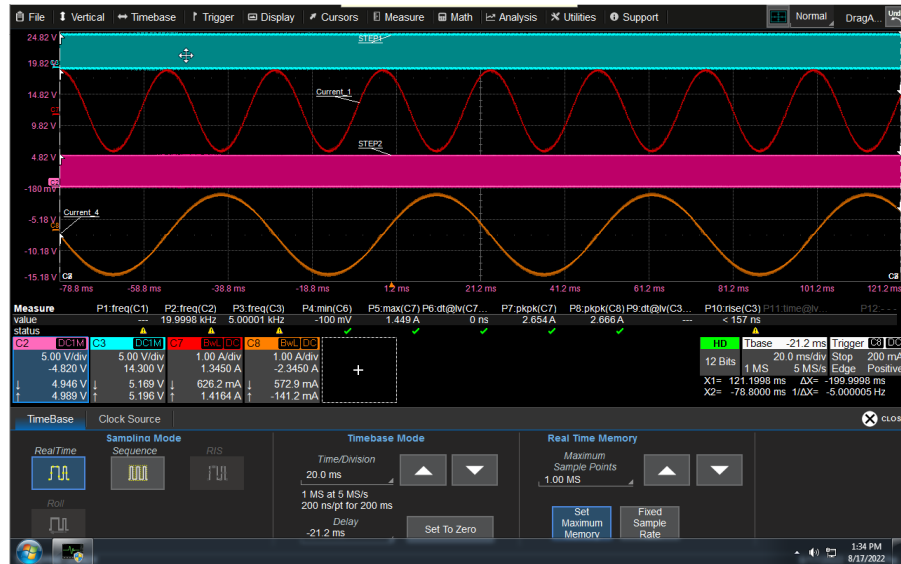
图 9-2. 驱动两个步进电机的 DRV8849
