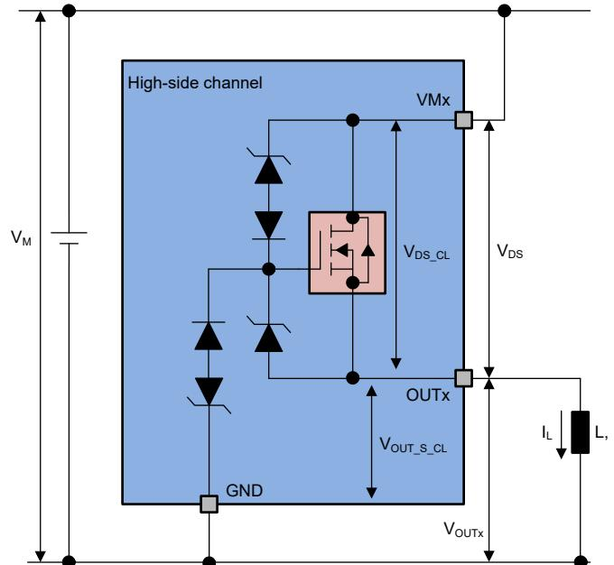
图 7-9. 高侧通道的输出钳位
