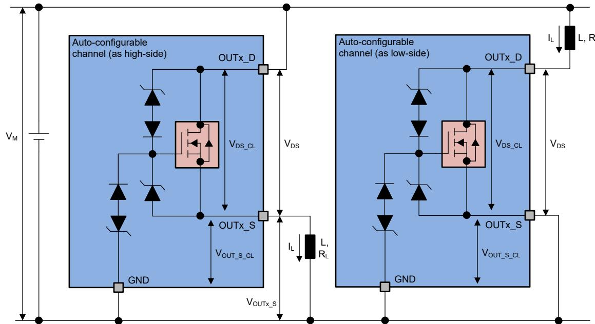
图 7-8. 自动可配置通道的输出钳位
