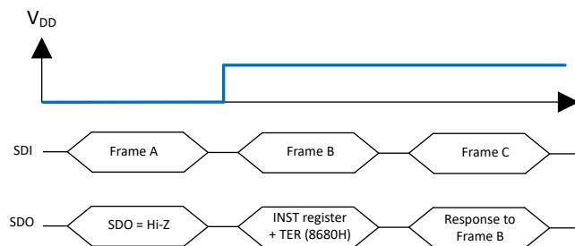
图 7-28. 退出  $V_{DD}$  上电复位后的响应
