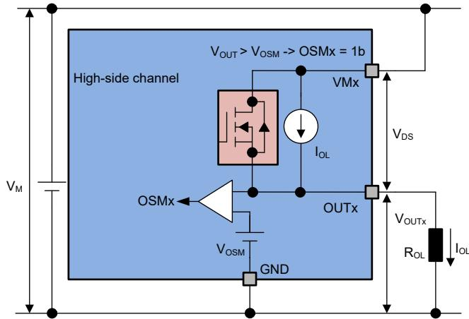
图 7-19. 输出状态监控 - 高侧通道
