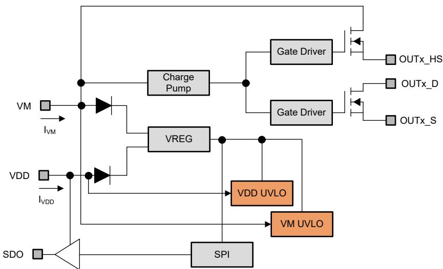
图 7-3. 内部电源架构
