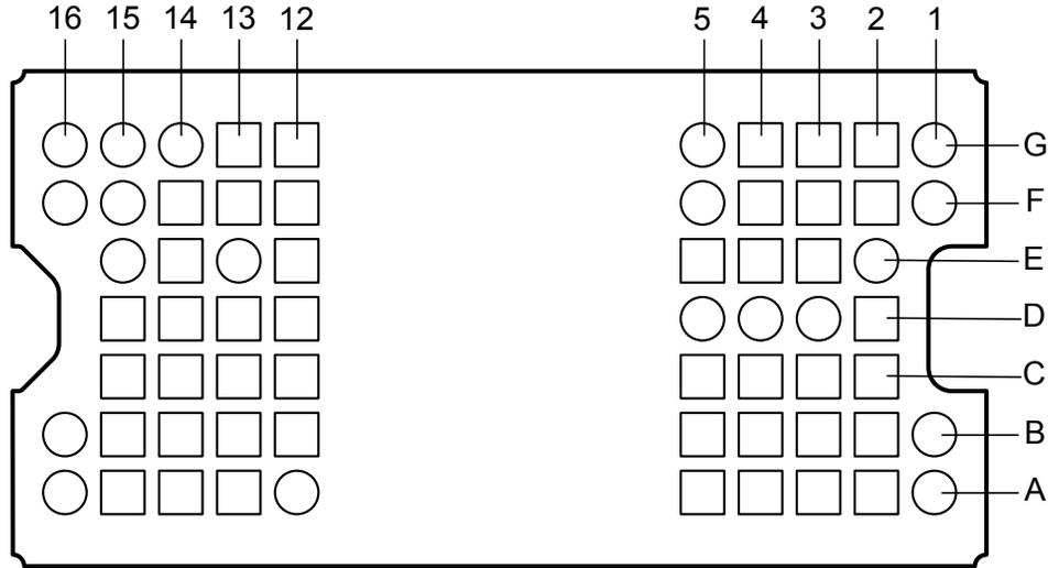
图 5-1. FQU Package 64-Pin LGA Bottom View
