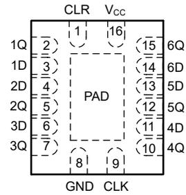
图 4-2. BQB Package, 16-Pin WQFN (Top View)
