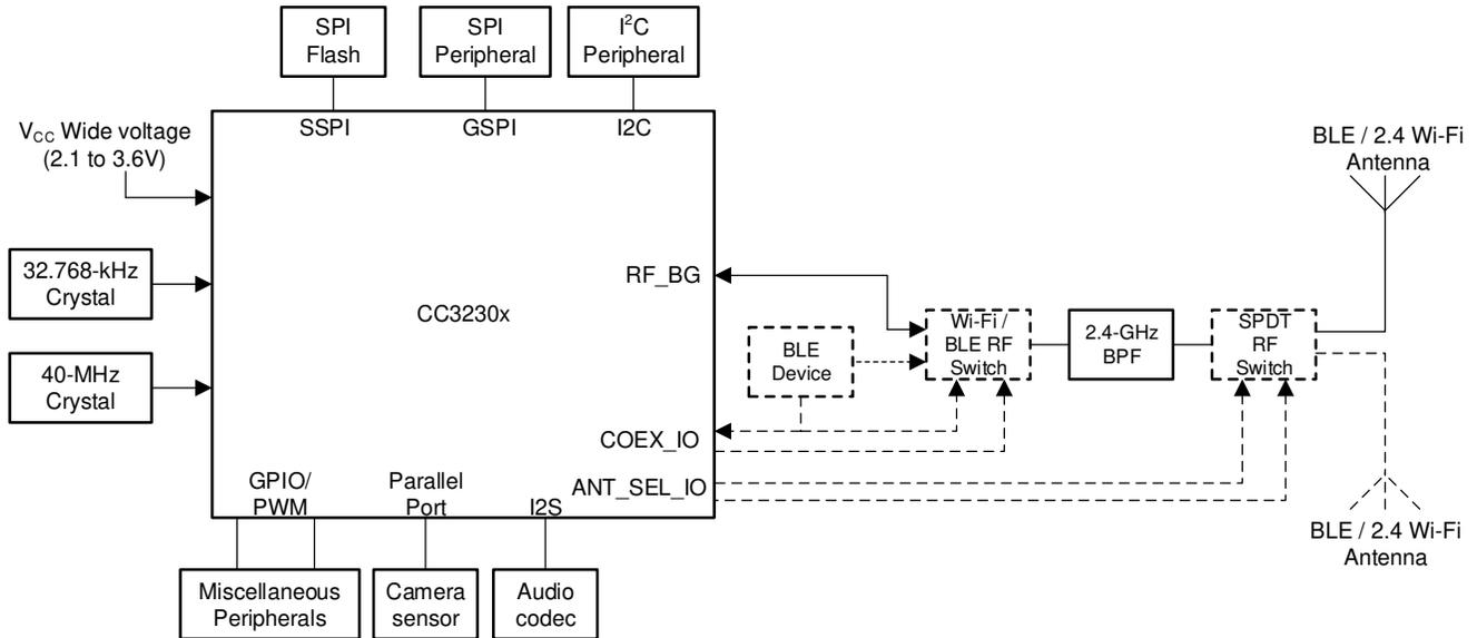
使用天线选择功能（双天线）时，需要应用 1 个 SPDT 开关和 2 条 GPIO 线路。
