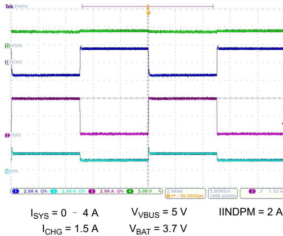
图 9-10. System Load Transient Response
