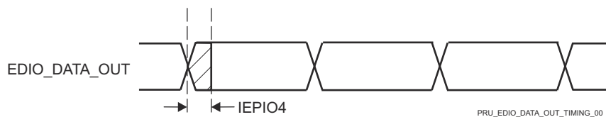
图 6-114. PRUSS IEP 数字 IO 时序要求
