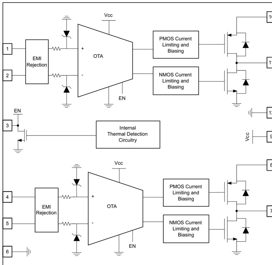
图 23. Functional Block Diagram
