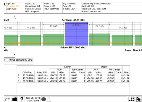
3.5GHz 匹配, 单载波 20MHz BW TM1.1 LTE
