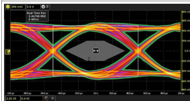
图 72. Eye 在 10-Gbps 位速率下具有增加输出摆幅
