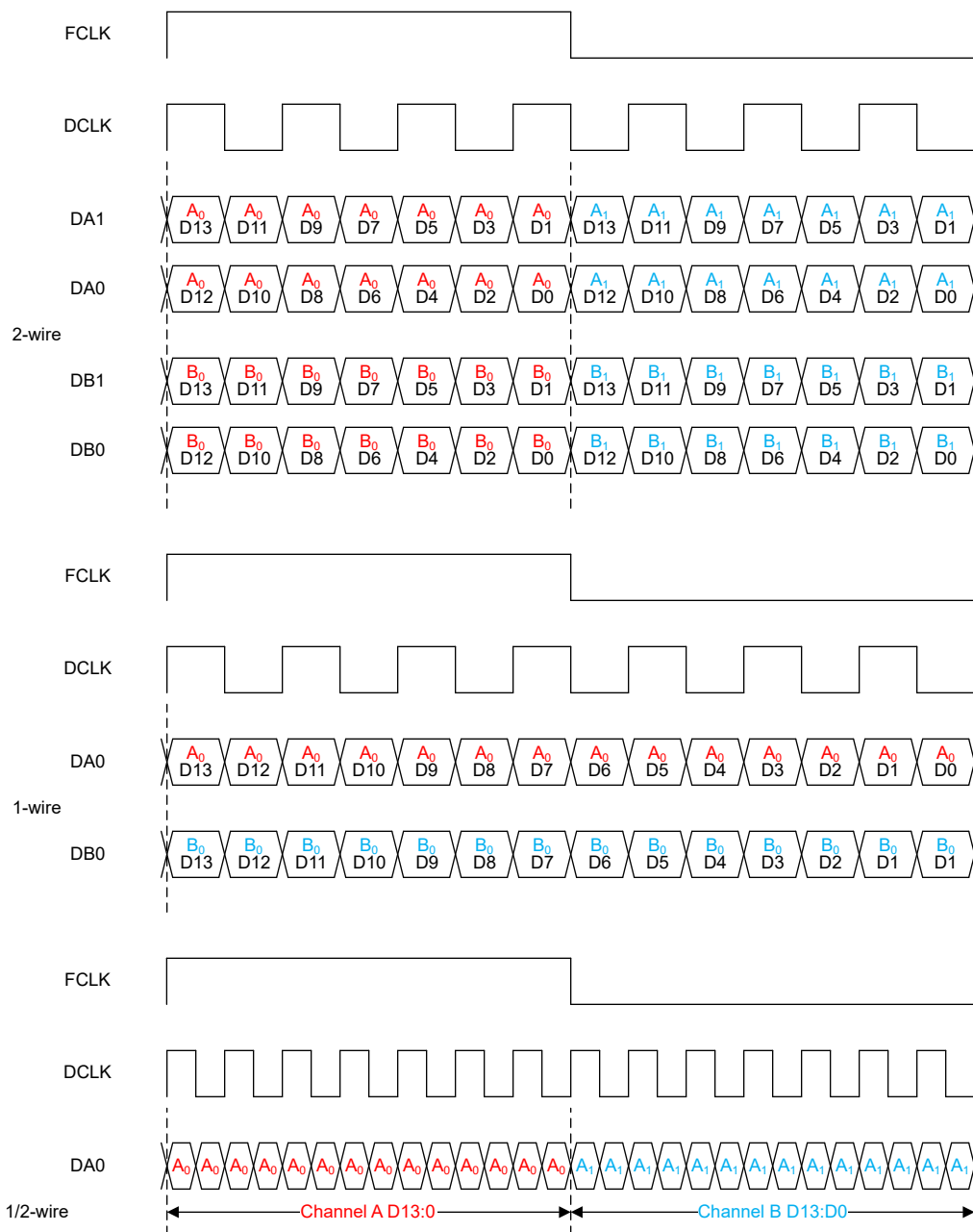
图 7-33. 实数抽取中的输出数据格式 ( 14 位输出分辨率 )
