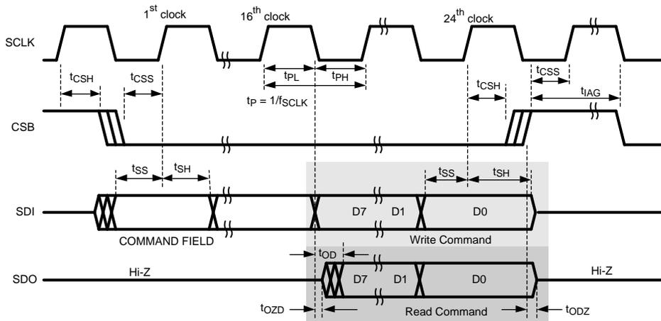
图 7. SPI Timing Diagram
