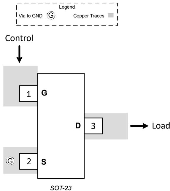
图 9-1. SOT-23 封装的示例布局
