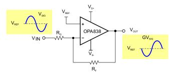
图 8-2. Inverting Amplifier
