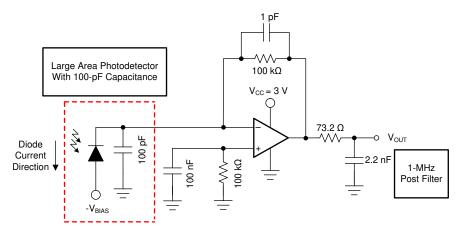
3V 单电源,小于 3mW 的光电二极管放大器,具有小于 1.1pA/ √Hz 的总输入参考电流噪声,并具有总体 SSBW 为 1MHz 的 100k Ω 增益
