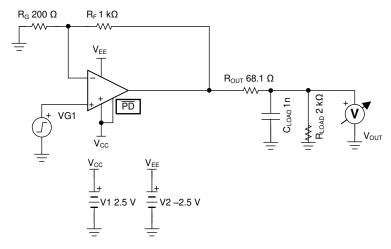
图 8-6. ROUT versus CL Test Circuit
