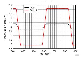
图 8-9. Bipolar-Supply Step Response
