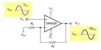
图 8-1. Noninverting Amplifier
