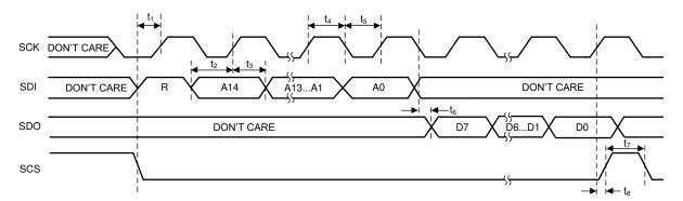
图 6-2. SPI 4-Wire Read Timing Diagram
