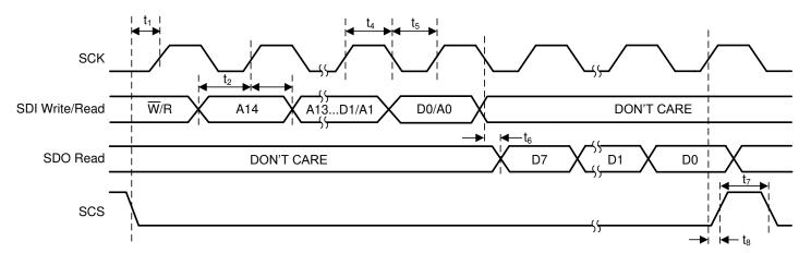
图 6-1. SPI Write Timing Diagram
