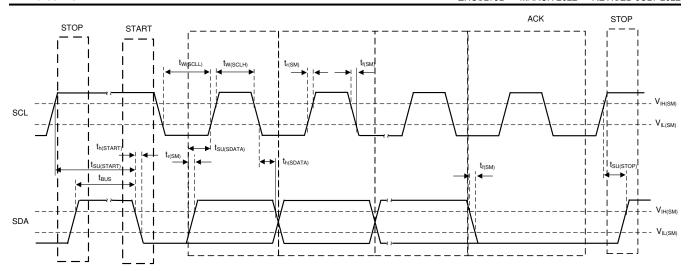
图 6-4. I<sup>2</sup>C Timing Diagram
