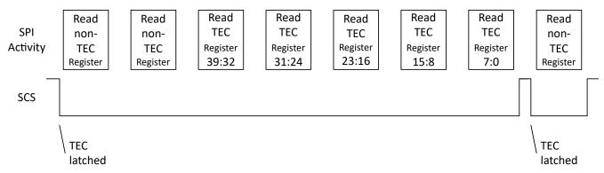
图 8-33. TEC Multibyte Read
