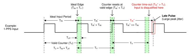
图 8-17. 1-PPS Input Window Detector Example
