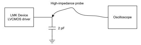
图 7-3. LVCMOS Output Time Domain Test Configuration
