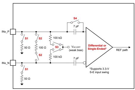
图 8-9. Reference Input Buffer
