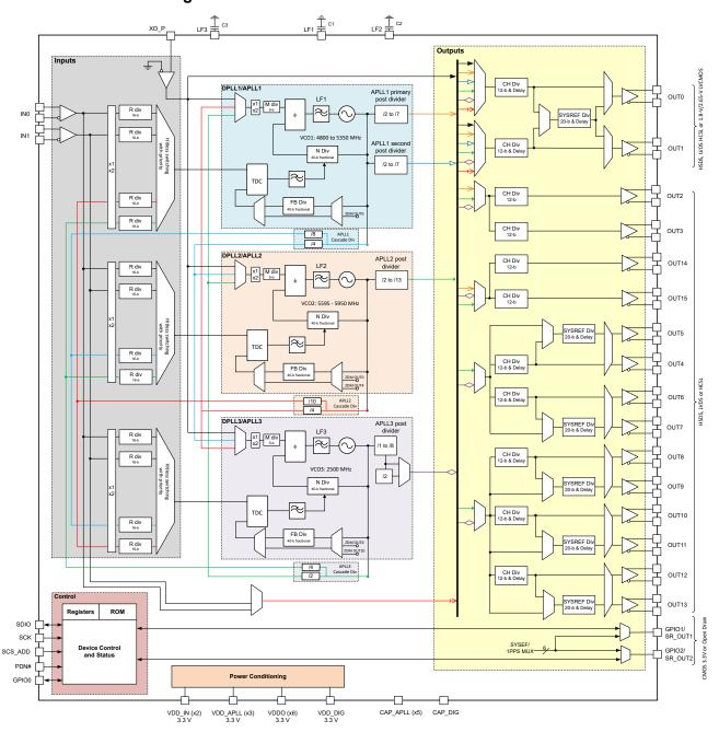
图 8-1. Top-Level Block Diagram
